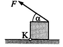
Horizontalen gespanntes Zugseil. Wie groß ist die erforderliche Zugkraft F? (**Drehmo-mentbilanz**; Verwenden Sie die Definition des Drehmomentes aus der Vorlesung Woche 4!)
